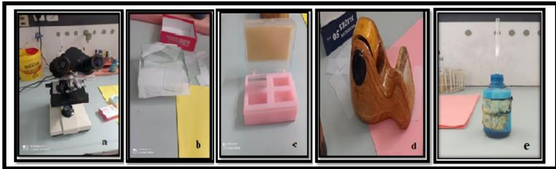
Figure 25 : Matériel de lecture ; a : Microscope optique à fond clair, b : lame, c : Lamelle, d : Scotch, e : Bleu coton, pipette.
