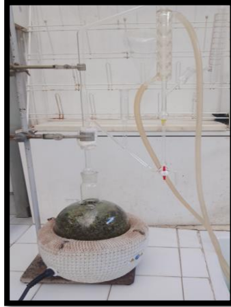
Figure 15 : Montage de l'hydrodistillation de type Clevenger (Photo personnelle)
