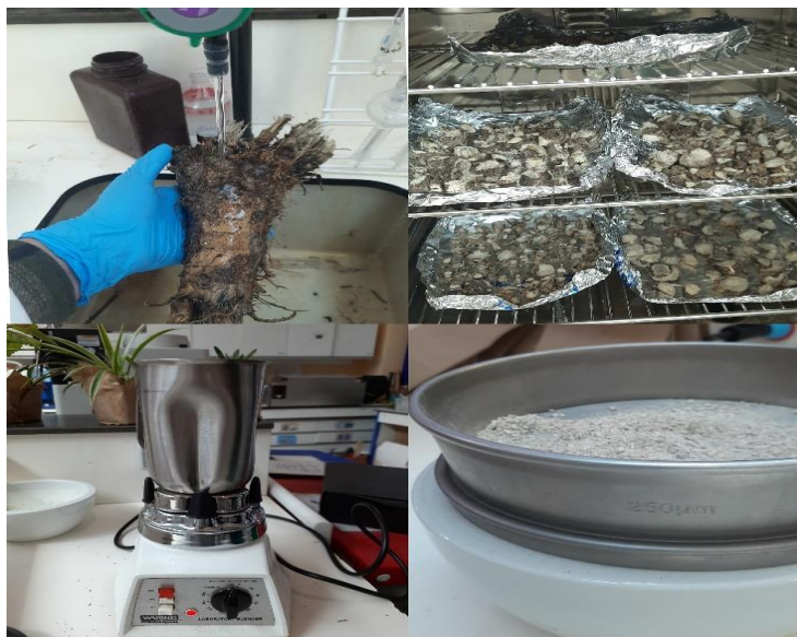
Figure 11: Photos prises des étapes de prétraitement des racines ( Beta vulgaris ) : lavage/ coupe /broyage/Tamissage.
