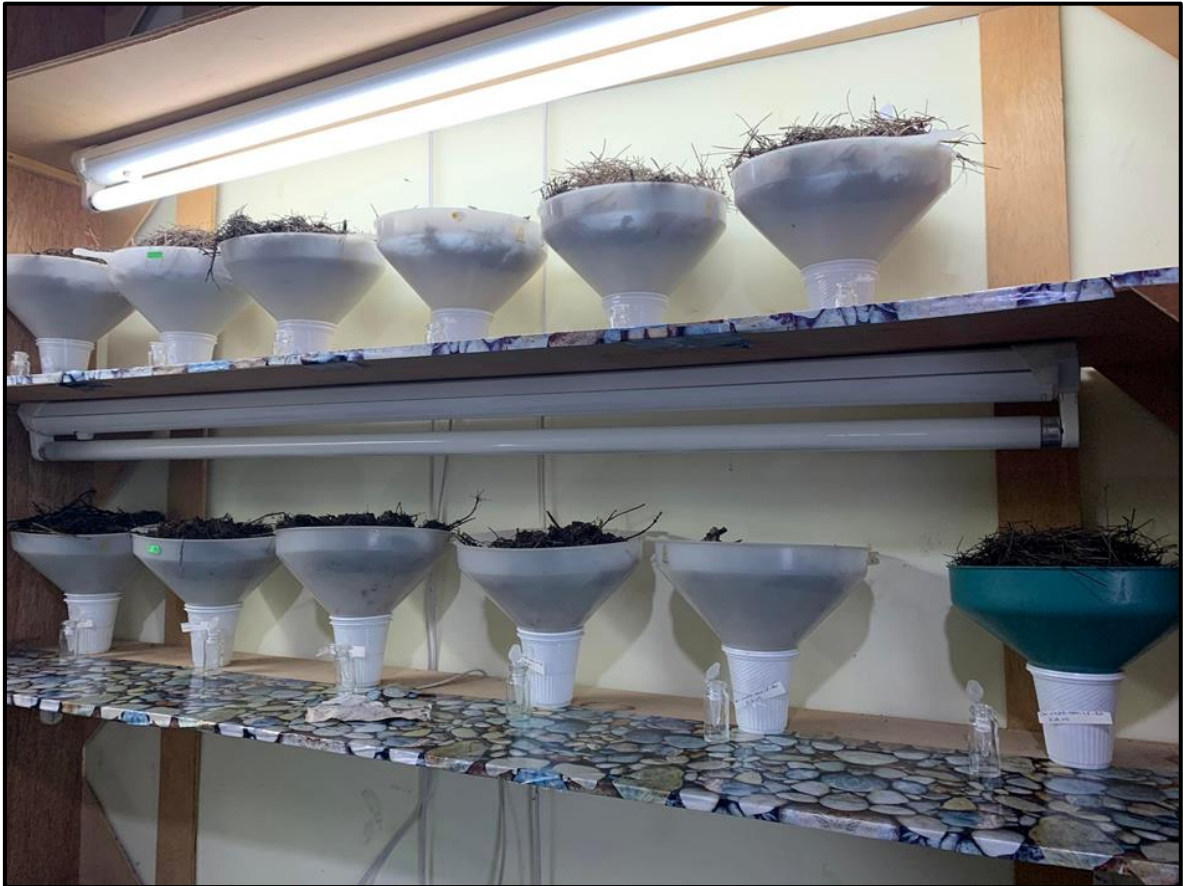
Figure 18. Appareil de Berlese pour l'extraction des Collemboles (Photo originale).
