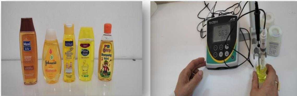
**Figure 4 :** Mesure de pH des échantillons
