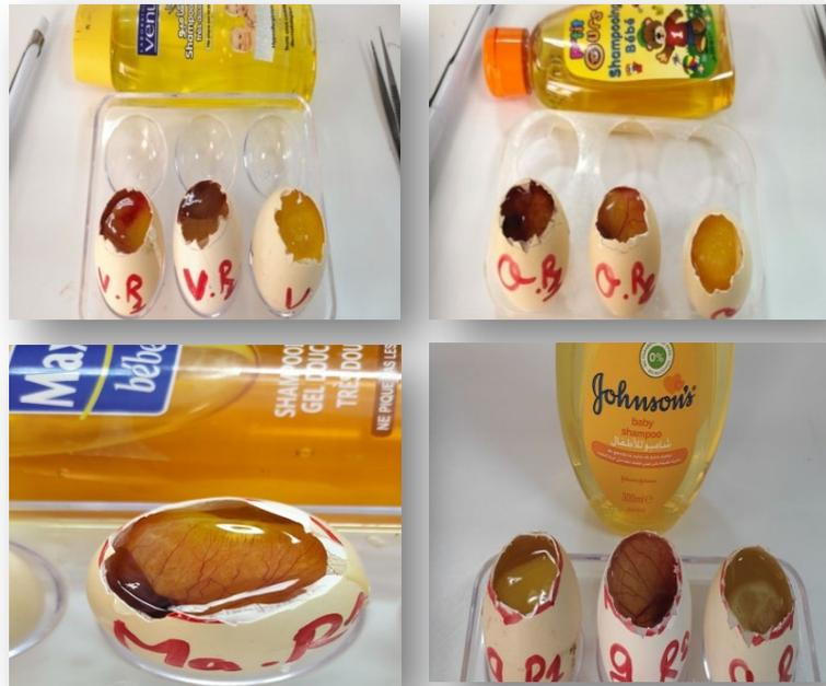
Figure 22 : Figures illustratives du test HET-CAM
