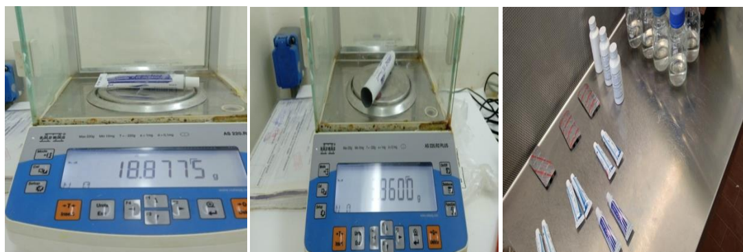
Figure 23: Contrôle de conformité de la masse moyenne
