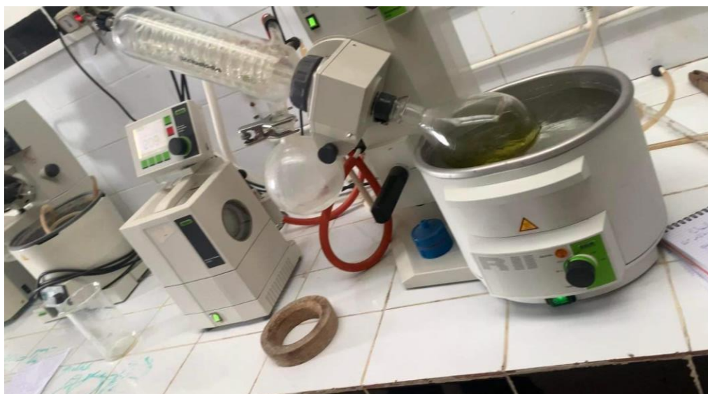
Figure 11 : Evaporation à l'aide du rotavapor au niveau du laboratoire ancien biopole de biologie, 2022 .
