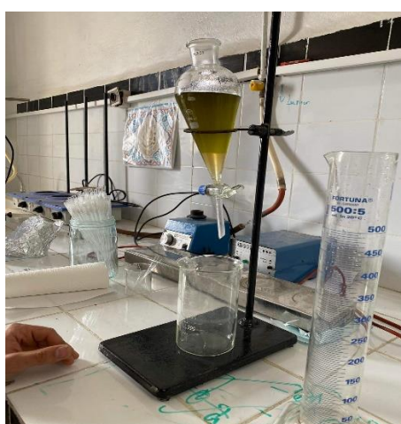
Figure 12 : séparation d'extrait (la formation des deux phases défèrent) au laboratoire ancien biopole de biologie, 2022.
