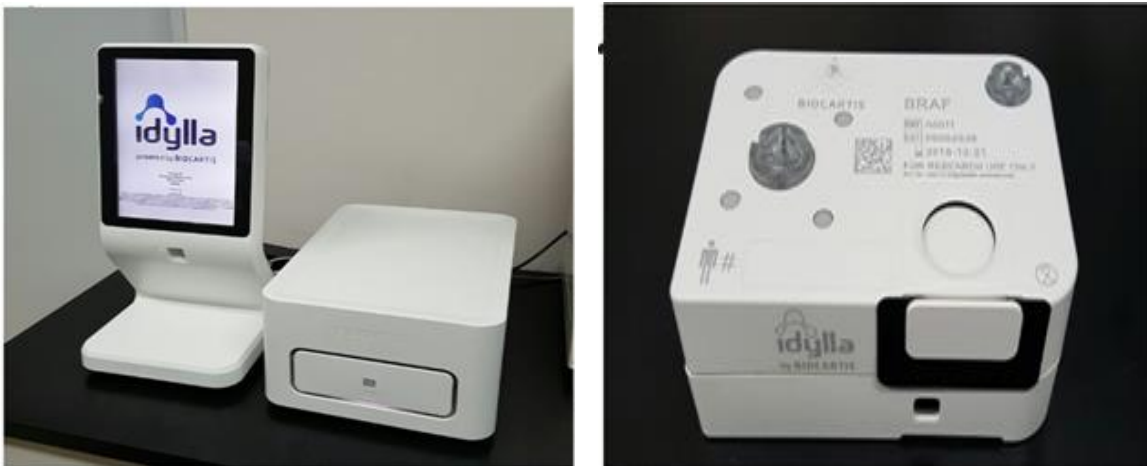
Figure 10. Automate utilisé pour la détection de mutations des gènes BRAF et KRAS.
