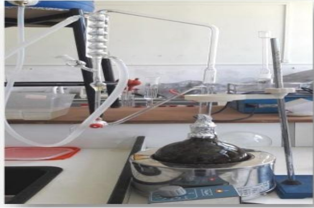
Figure 14 : Montage d'extraction de type Clevenger [25].
