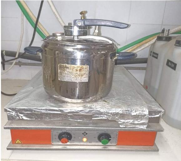
**Appareil 1 : Autoclave**
