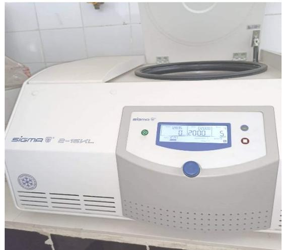
**Appareil 4 : Centrifugeuse (Sigma)**
