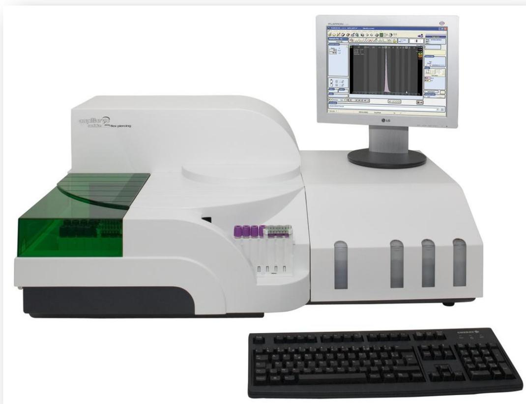
**Figure 19** : automate SEBIA CAPILLARYS 2 conçu pour l'électrophorèse capillaire
