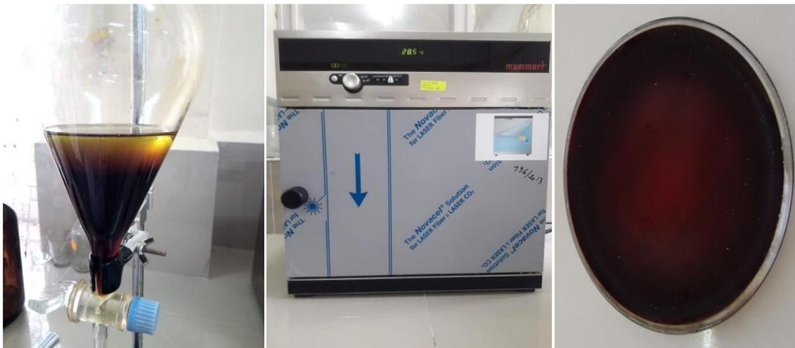
**Décantation****Séchage****Extrait obtenu****Figure27 :** Récupération de l'extrait
