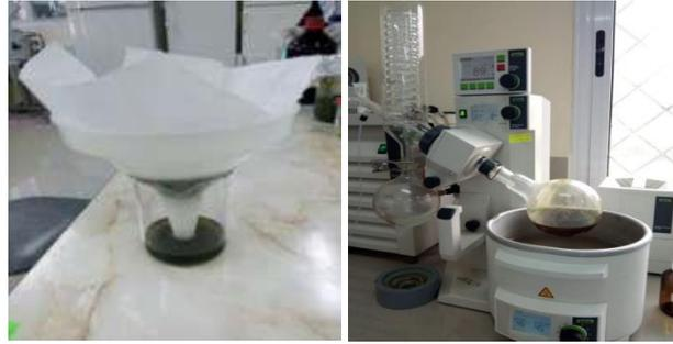
**4- Filtration****5- Evaporation****Figure 26:**Préparation de l'extrait hydro alcoolique
