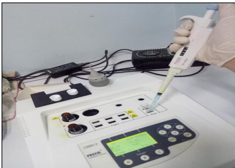
Figure 13 L'appareil «C2000-1/2/4 Semi-Auto Coagulation Analyzer » appliqué pour mesurer le temps (TCK) et (TQ)
