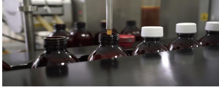
Figure 16: Ligne de remplissage et de sertissage (81).
