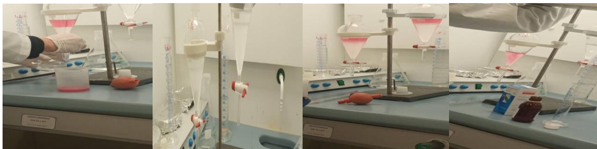
Figure 30: Dosage des conservateurs (extraction liquide).
