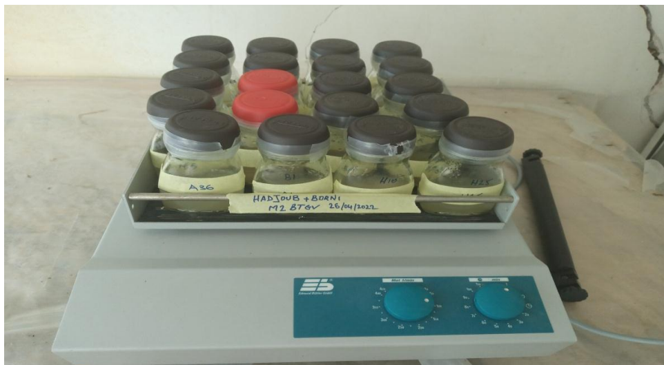
Figure06. Dispositif expérimentale pour l'étude de la solubilisation du phosphate sur milieu liquide
