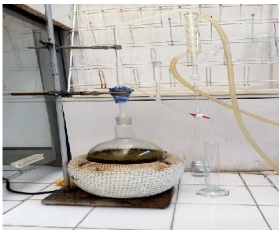
Figure 12 : Photographie du dispositif utilisé pour l'extraction des HEs par hydro distillation.(clevenger)
