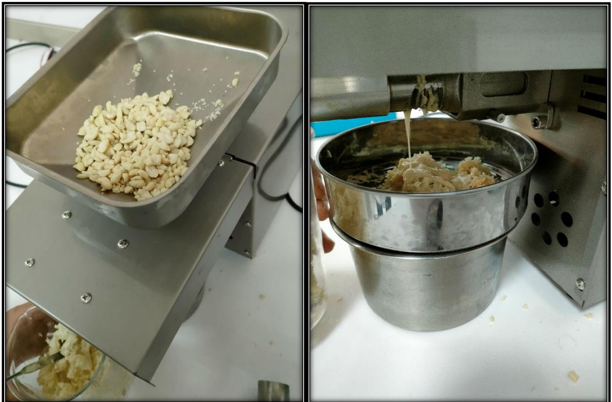
Figure 15 : Extraction de l'huile d'arachide.
