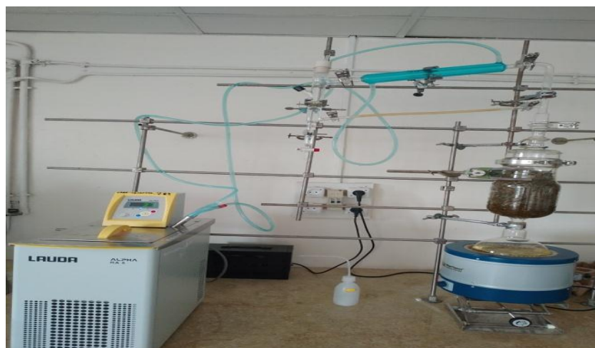
Figure 14 : Dispositif de la distillation par entraînement à la vapeur d'eau (Photo Dr Atmani-Merabet, février 2022)
