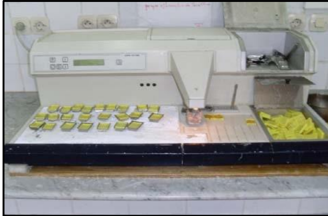
Figure 22 : Module d'enrobage complet.
