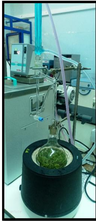
Clevenger (Extraction huilles essentiels ) (Bentrad.F,hamzaoui.y ,2022)
