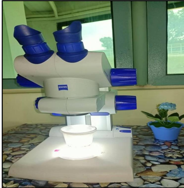
**Figure 14.** Loupe binoculaire de marque « Carl Zeiss » à grossissement X32
