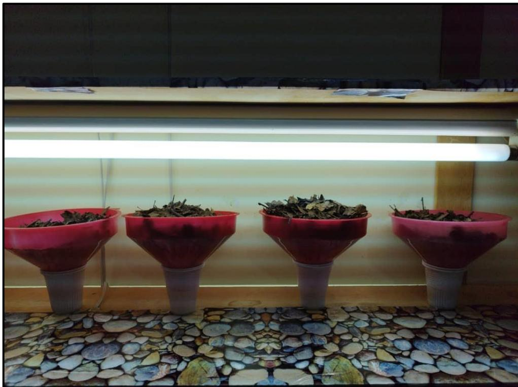
**Figure 12.** Extraction des collemboles par la méthode de Berlèse (Photo originale)
