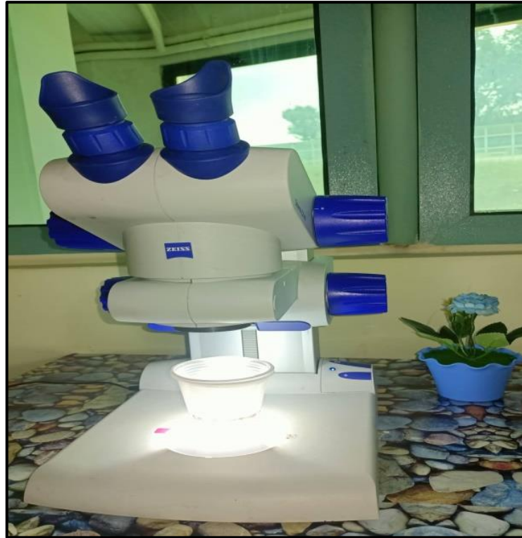
Figure 11. Loupe binoculaire de marque « Carl Zeiss » à grossissement X32
