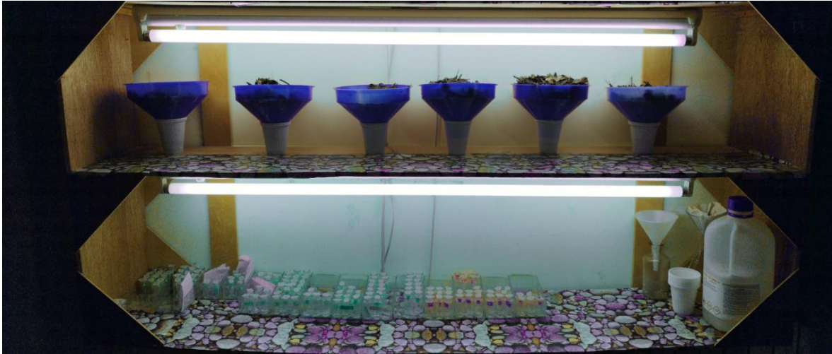
Figure 09. Appareil de Berlese pour l'extraction des Collemboles (photo original)
