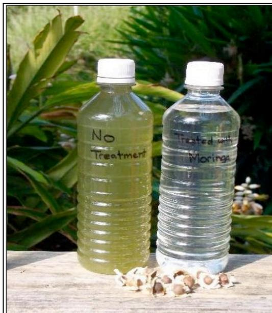
**Figure 10** Utilisation des graines de *M. Oleifera* Lam. dans la purification d'eau (Site2).
