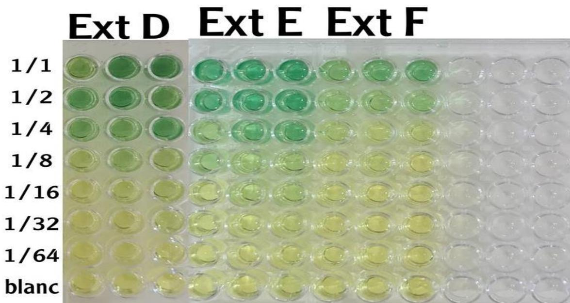
Figure 31 : résultats du test ABTS sur microplaques.
