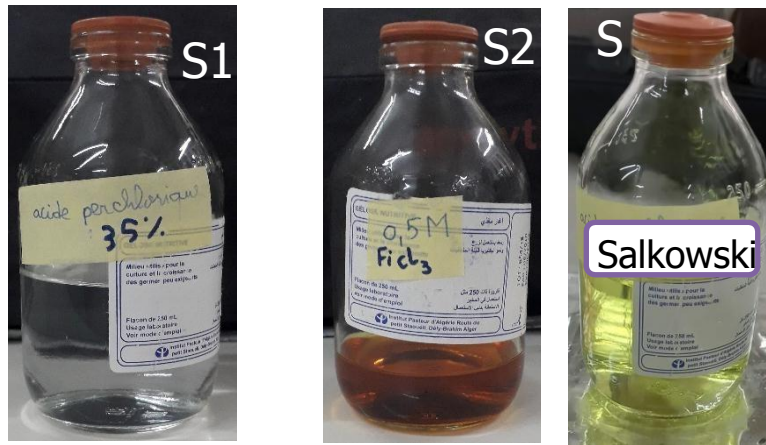
Figure 16: Préparation du réactif de Salkowski : S1 (acide perchlorique), S2 ( \text{FeCl}_3 ), S (Salkowski).
