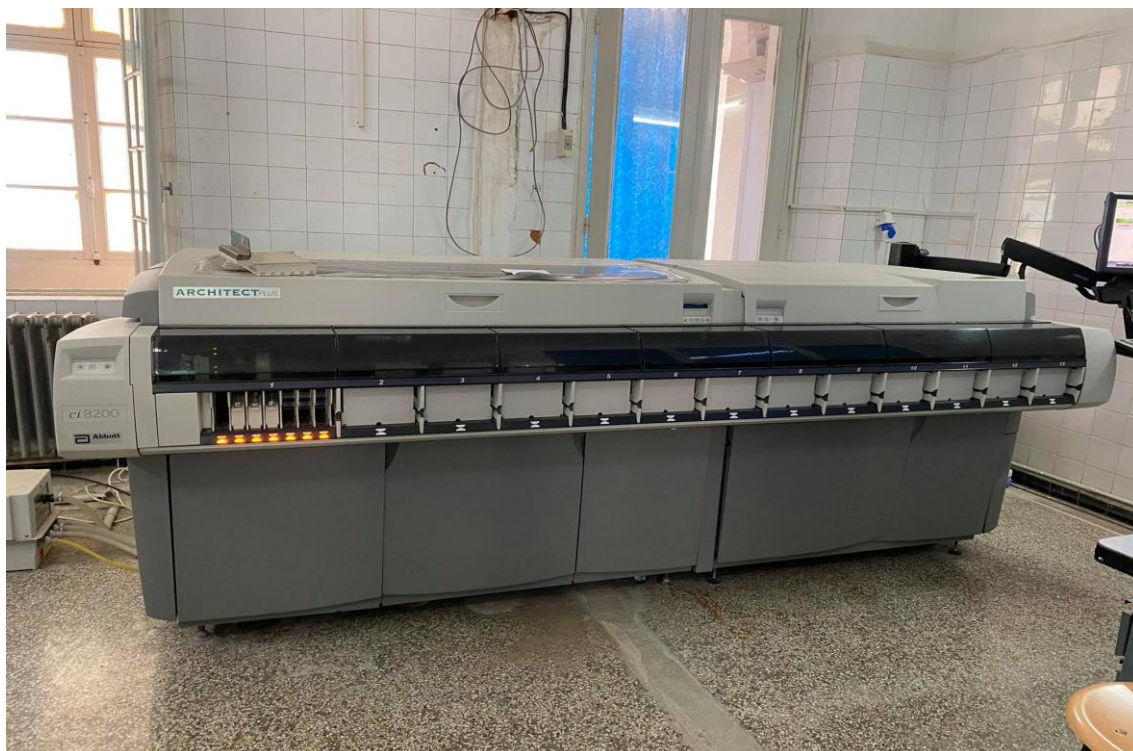
Figure 20 : Automate système optique ARCHITECT Ci 8200
