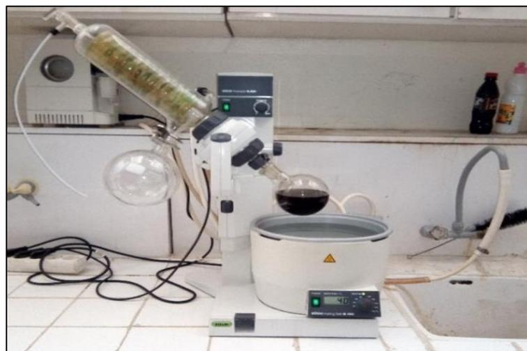
**Figure 6 :** Elimination du méthanol par l'évaporateur rotatif.
