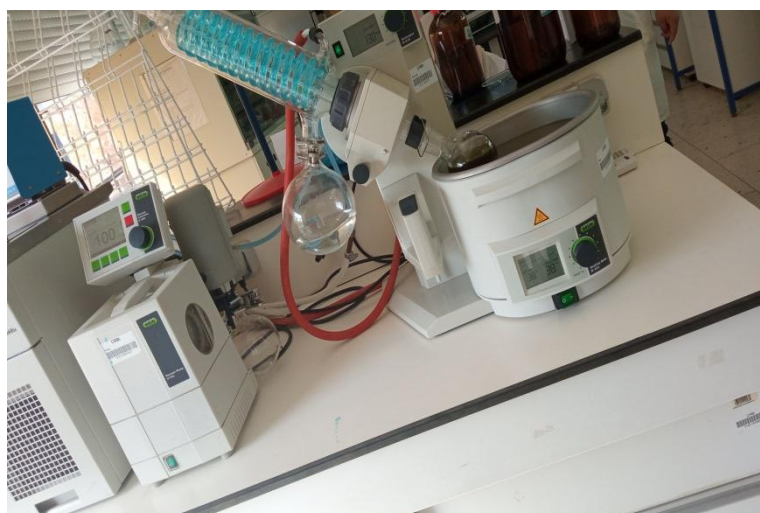
Figure 10 . Evaporateur rotatif utilisé pour l'élimination du solvant d'extraction.
