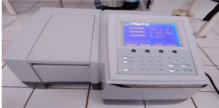
**Figure 09 :** Appareil UV –Spectrophotomètre
