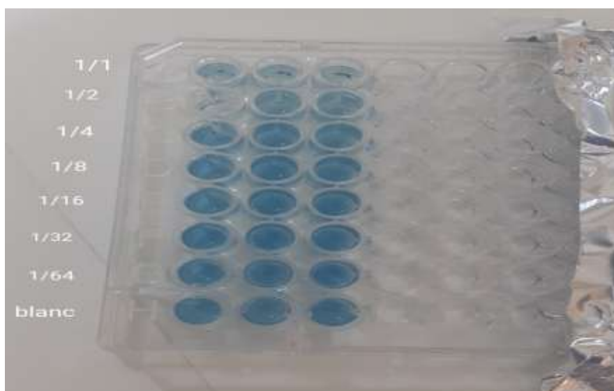
Figure 19. Plaque de dosage de l'activité de réduction du complexe cuivre-néocuproïne d'extrait résidus d'orange
