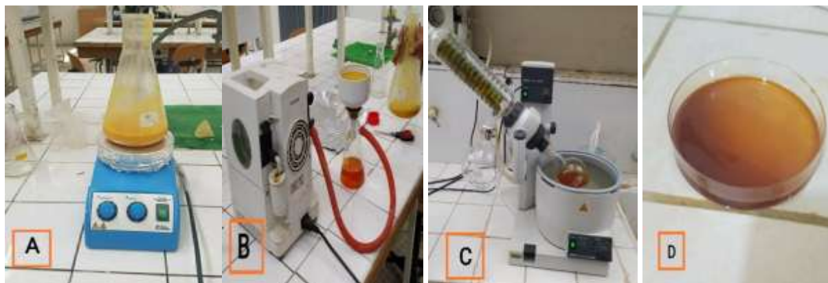
Figure 12 : Les étapes de préparation de l'extrait ( A : Macération ; B : Filtration ; C : Evaporation à pression réduite ; D : Extrait brut
