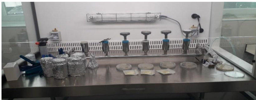
Figure 22 : Méthode de filtration sur membrane
