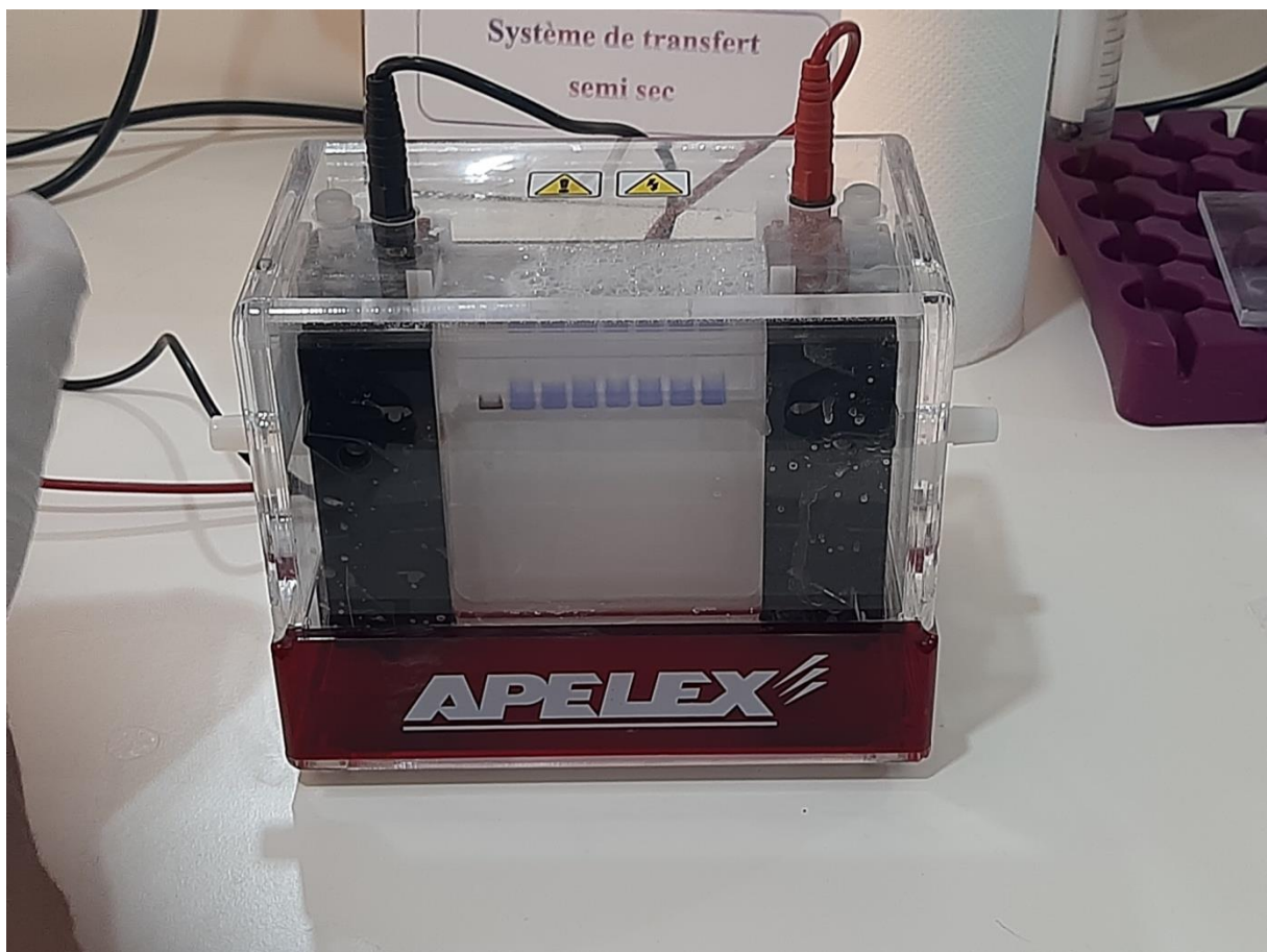
Photo. 01 : technique de séparation des protéines fonctionnant par un gel de polyacramide.
