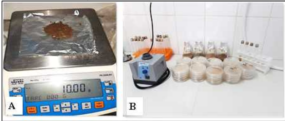
Figure 16. Préparation de dilution. (A) Pesée du sol pour la solution mère ; (B) Préparation des dilutions jusqu'à 10^{-4}
