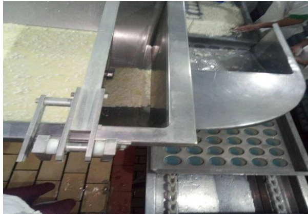
Figure 8 : moulage et égouttage des caillés du camembert.
