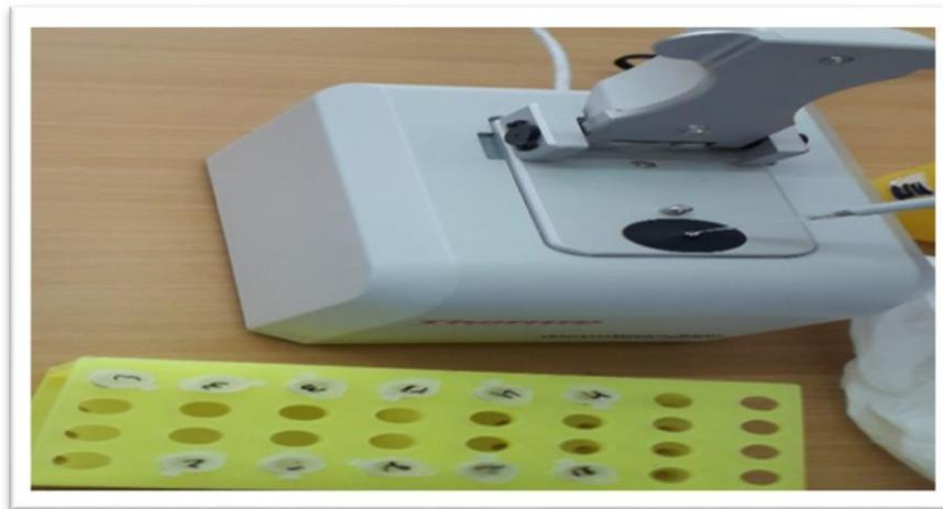
*Figure 14 Dépôt d'un échantillon sur Nano drop*
