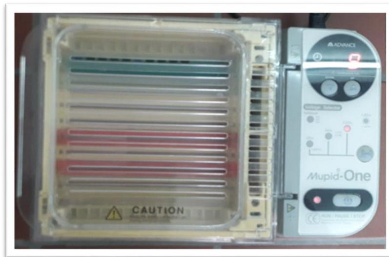
**Figure 18** Migration des échantillons par électrophorèse sur gel d'agarose 0.8%,40 mn a 100V.
