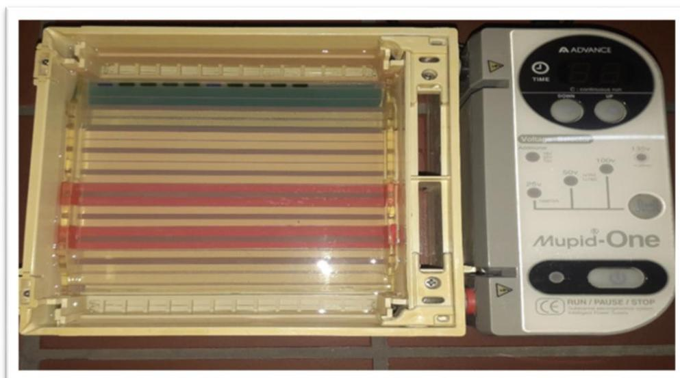
*Figure 17* Dépôt des échantillons sur gel
