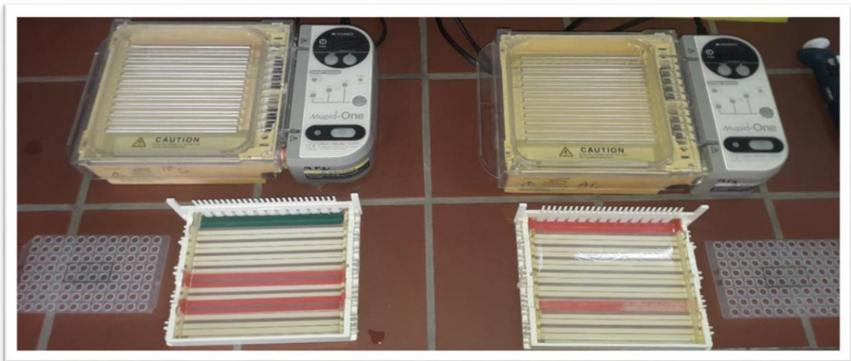
*Figure 15: préparation pour déposer les échantillons sur deux gels*
