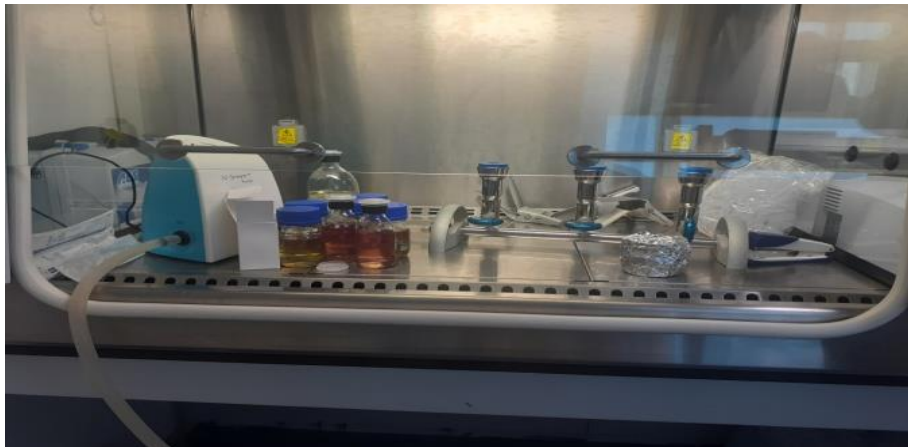
Figure 23 : Rampe de filtration.
