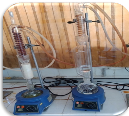
Figure 13 : Extraction d'huile des grignons d'olive (Dispositif Soxhlet).
