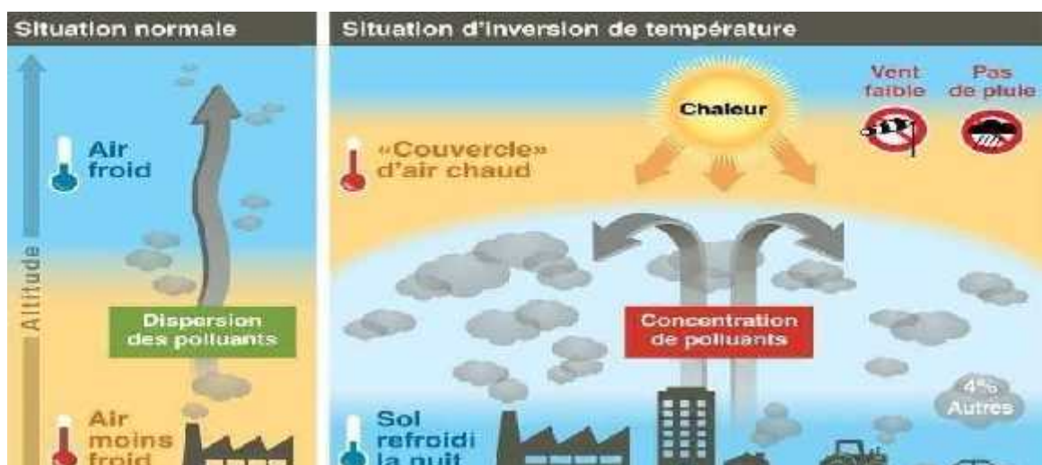
Figure 02 : Influence du phénomène de l'inversion thermique sur la dispersion des polluants (Sermondadaz, 2016).
