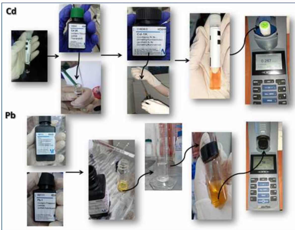
Figure 16: Processus de la détermination des teneurs en cadmium et en plomb par le Photomètre PhotoFlex STD WTW®.
