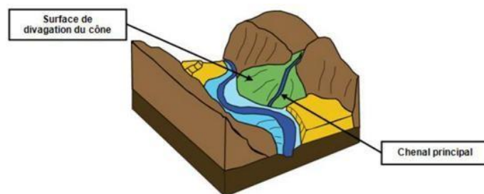
Figure 10: Structure morphologique d'un cours d'eau torrentiel
