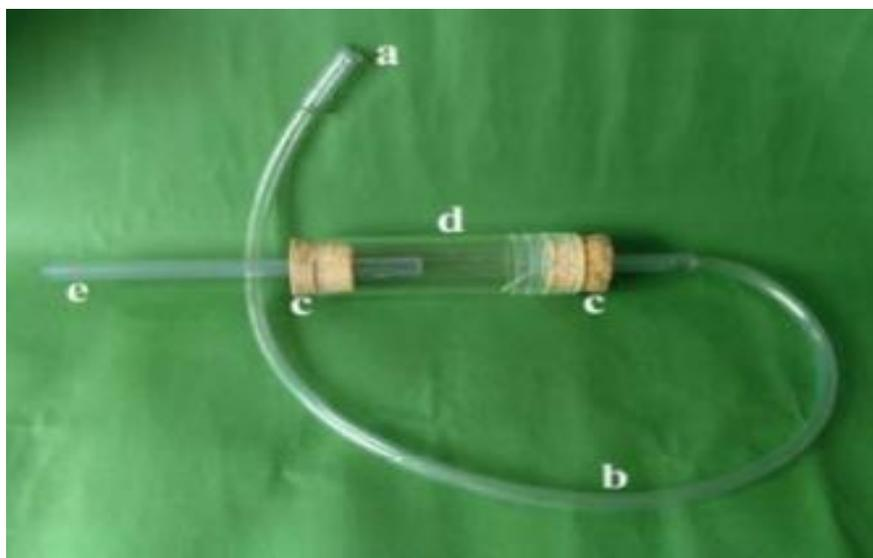
**Figure 22** - Aspirateur à bouche standard a : embout d'aspiration , b : tube d'aspiration en PVC, c : bouchons , d : corps de l'aspirateur , e : tube collecteur (FRANCK . , 2013).
