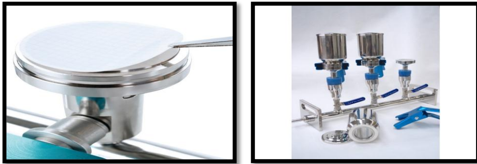
Figure 35 : Rampe à filtration sous vide + la membrane filtrante [125, 126].
