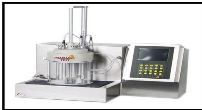
Figure 10 : Testeur de désagrégation [63].
