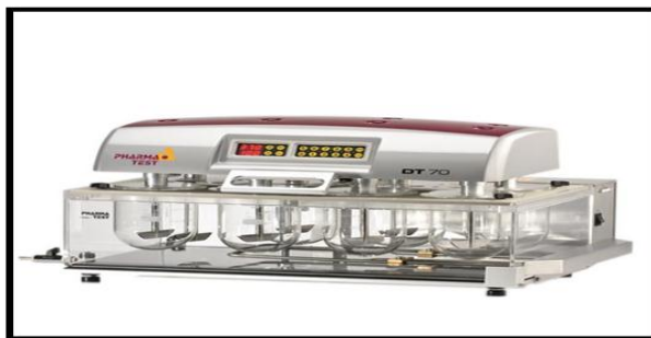
Figure 11 : Testeur de dissolution [65].
