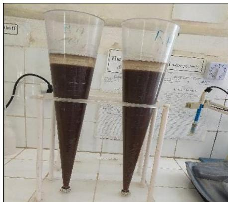
**Figure 21** Mesure de V<sub>30</sub>.
