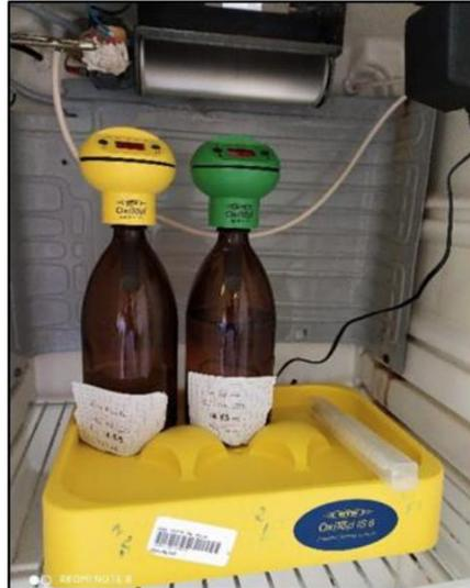
**Figure 20** Dispositif de mesure de la DBO<sub>5</sub>.
