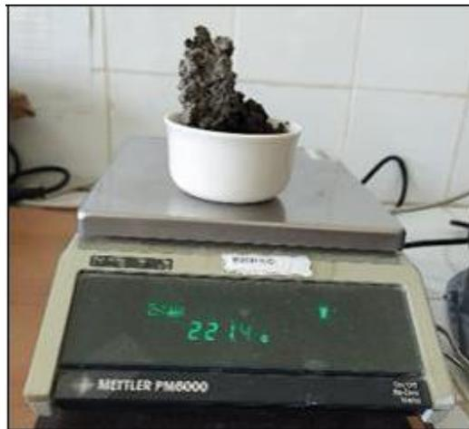
Figure 22 Mesure de la siccité.
