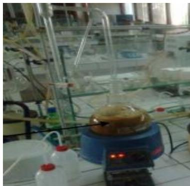
**Figure 12:** Extraction de l'HE par hydrodistillation à l'aide d'appareil de type Clevenger (El- Mansouri., 2013).
