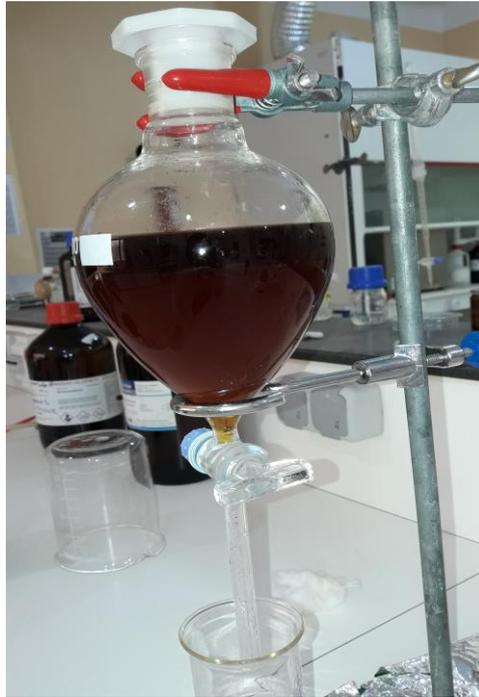
**Figure G :** Extraction par le solvant d'acétate d'éthyle
