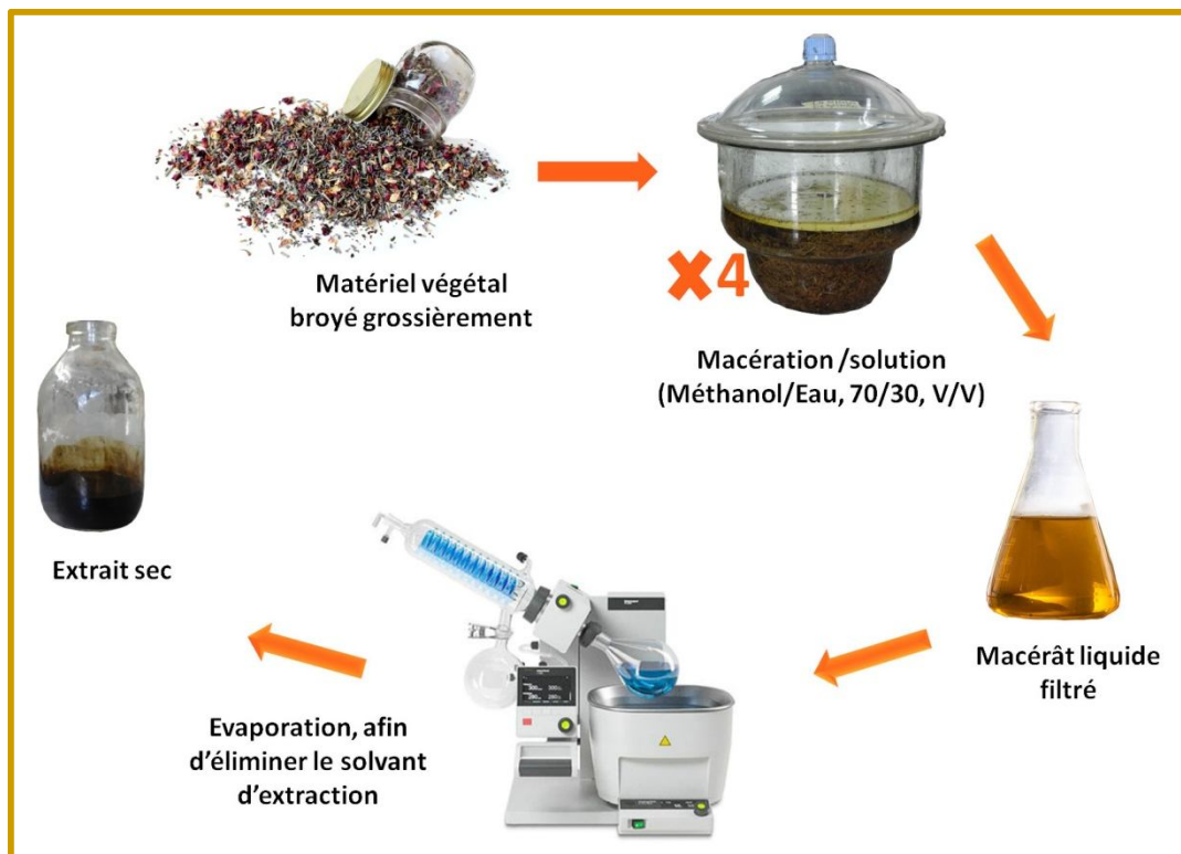
Figure 14 : Schéma récapitulatif des étapes d'extraction par macération jusqu'à l'obtention de l'extrait sec.
