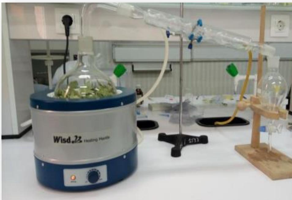
**Figure II.1 :** Montage d'hydrodistillation (Clevenger) (Penchev PI., 2010).
