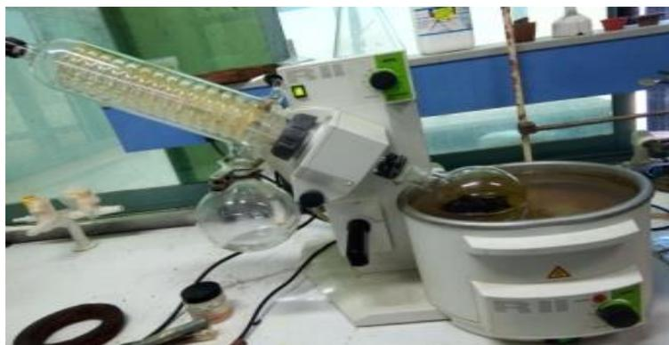
**Figure11:** Procédé de concentration de l'extrait (évaporateur rotatif).
