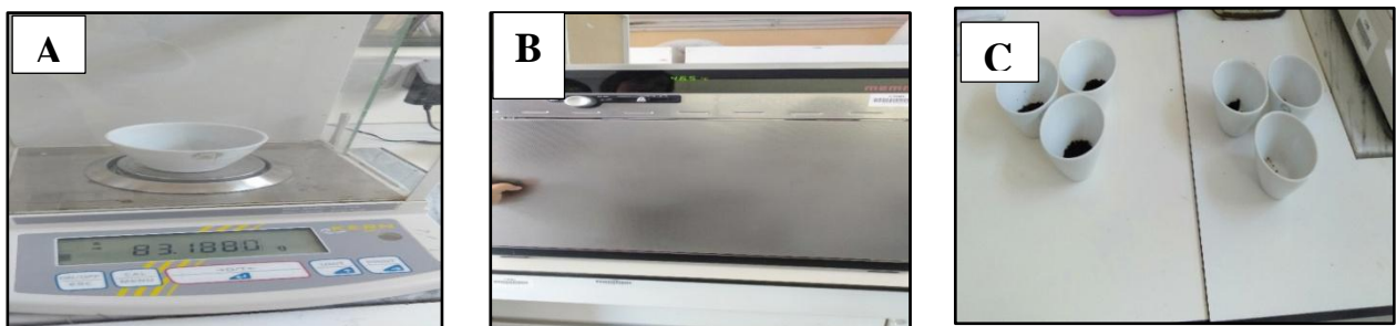
Figure 18 : Détermination de la matière sèche (A : La pesée des échantillons ; B : Etuve ventilée ; C : Echantillons secs).
