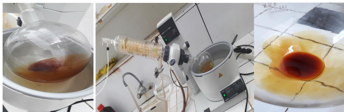
Figure 16 : élimination du solvant par l'évaporateur rotatif
