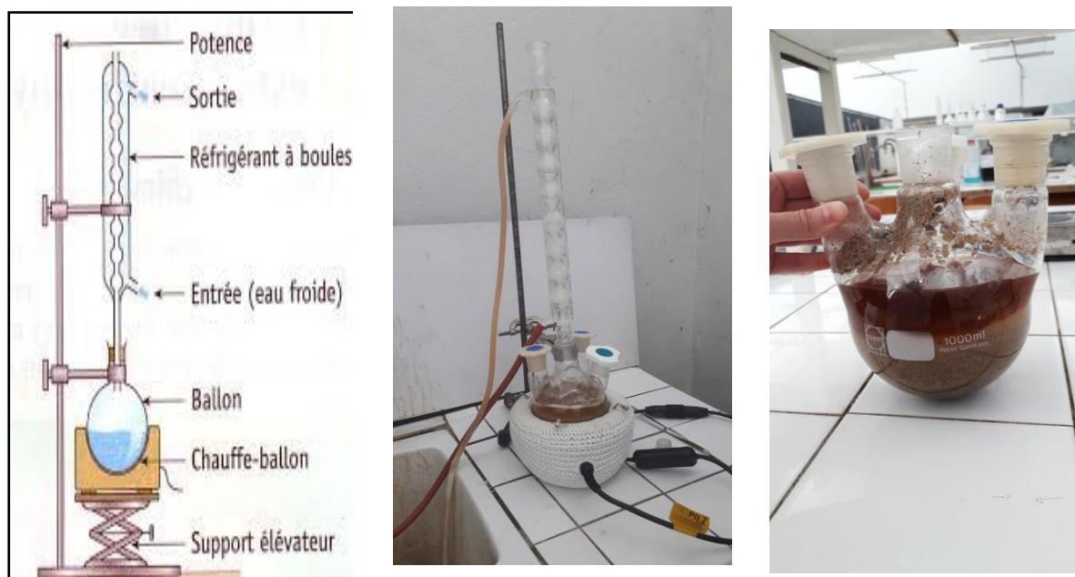
Figure 14 : montage de chauffage à reflux
