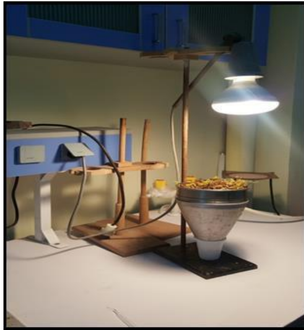
Fig. 21. Extraction par appareils de Berlese.
